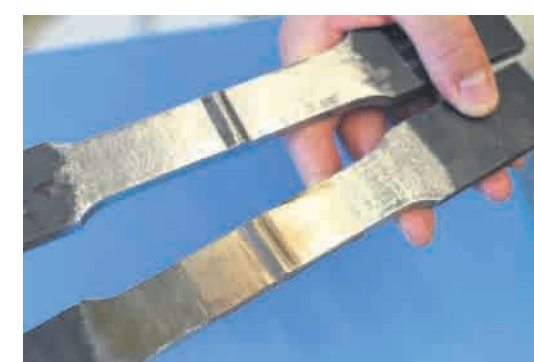
Die kupferfarbene Beschichtung auf dem Eisenstück ist das „Nanopflaster“, zum Vergleich daneben ein Eisen ohne Nanopflaster.
